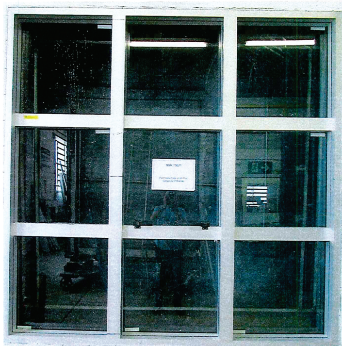
Foto n.º 04 – Visualização do ensaio de permeabilidade ao ar após cargas uniformemente distribuídas
